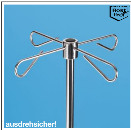
Flaschenkreuz KLINIK 3 - elektro- poliert massiv Edelstahl zum absturzsicheren Anschrauben mit Trop- fenabriebkante, Nenn- traglast 3 kg je Haken. Haken nach DIN ISO 15375:2014-10 für Stativrohr Ø 16 mm mit Gewinde M8 Nr. LD 41 44 € 24,-/St. für Stativrohr Ø 25 mm mit Gewinde M8 Nr. LD 41 77 € 25,-/St.
