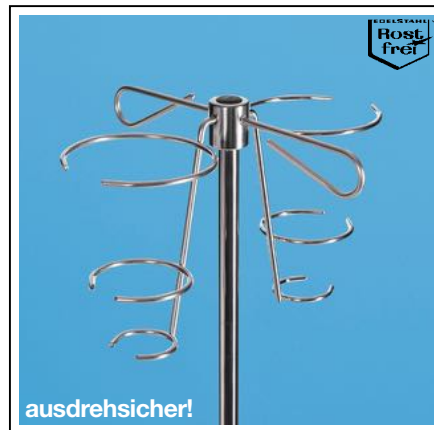
Flaschenkreuz KLINIK 3 - elektro- poliert massiv Edelstahl zum absturzsicheren Anschrauben mit Trop- fenabriebkante, Nenn- traglast 3 kg je Haken. Haken nach DIN ISO 15375:2014-10 für Stativrohr Ø 16 mm mit Gewinde M8 Nr. LD 41 44 € 24,-/St. für Stativrohr Ø 25 mm mit Gewinde M8 Nr. LD 41 77 € 25,-/St.
