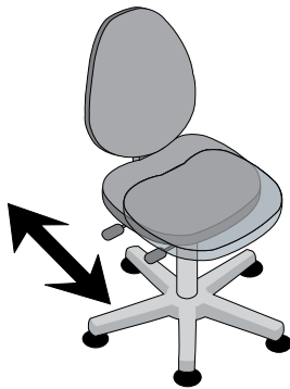
Sitztiefenverstellung durch Schiebesitz um 7 cm
