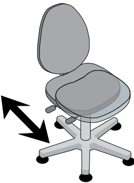
Sitztiefenverstellung durch Schiebesitz um 7 cm
